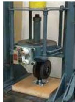
※周辺構造体：キャスタを固定する合板、ビス、木ネジ、鬼目ナットなどの総称とする。総合的な製品強度の試験ではキャスタと周辺構造体を合せて実施。
