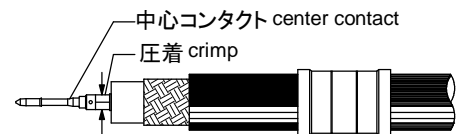
クリンプハイトを確認する Measure crimp height
